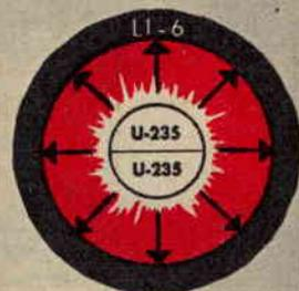
Questi diagrammi indicano uno dei possibili disegni della bomba H. Uno strato di Li-6 circonda una piccola bomba atomica (sopra). Quando la bomba A esplose, neutroni bombardano il Li-6 che produce tritio provocando un'esplosione stellare (sotto). - A destra: Molto probabilmente la cipria di cui si serve questa signora è a base di litio.
