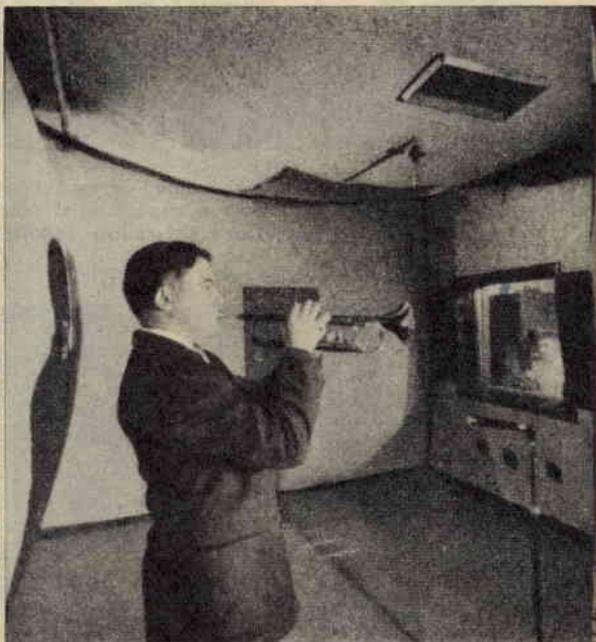
A sinistra: Prima di adattare i pistoni nei cilindri delle valvole, la tromba è pulita e brunita. Questa operazione deve precedere il montaggio dei pistoni poichè altrimenti potrebbe variare la perfetta tenuta dei pistoni nei cilindri. A destra: Un esperto suona la tromba in una sala di prova. Il soffitto e le pareti rigonfie eliminano le superfici parallele in modo che i suoni abbiano minor distorsione per l'eco.
