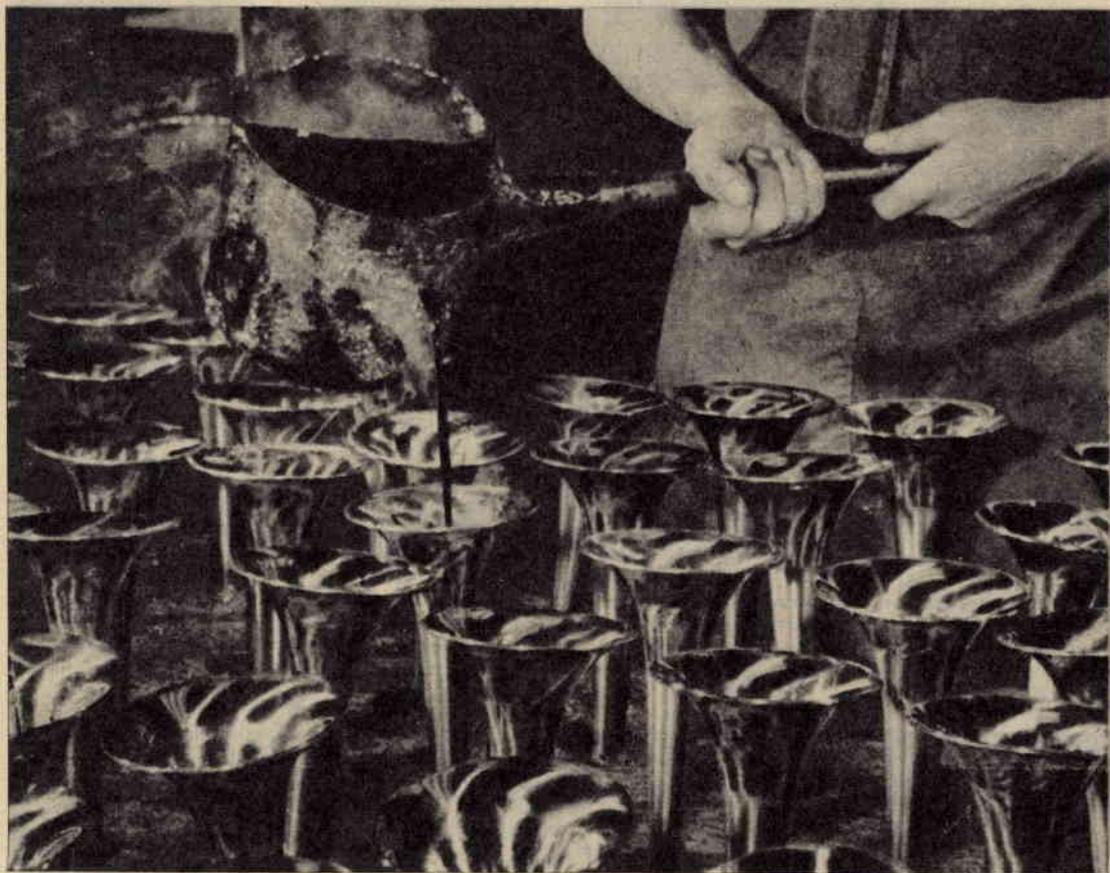
Pece calda viene versata nella « campana » e lasciata indurire. Questo riempimento solido mantiene inalterato il diametro critico interno e impedisce al tubo di deformarsi durante la delicata operazione di curvatura. Ogni piccola variazione del calibro influisce notevolmente sul tono della tromba.
